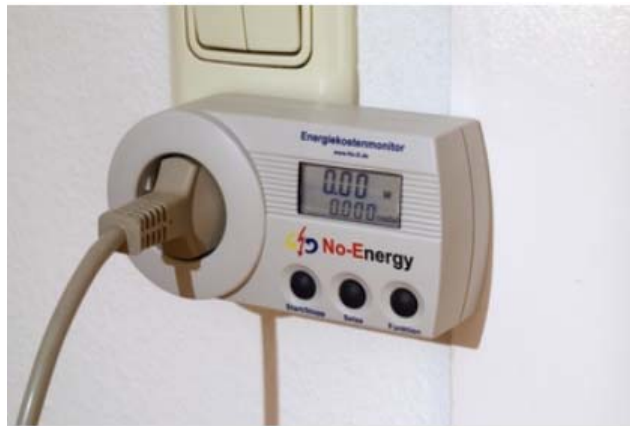
Energiekostenmonitore helfen, stille Stromfresser zu identifizieren. Foto: Haacks
