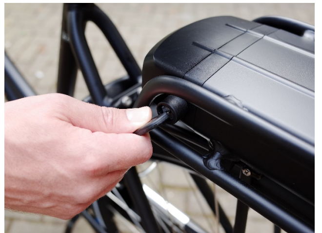
Schloss auf rechts: Akku raus. Schlüssel nicht beim Herausnehmen des Akkus drehen!
